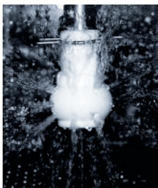
Reinigungsdüsen in verschiedenen Ausführungen, spezielle CIP-Düsen.
